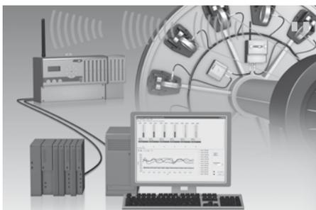
**RTM (Беспроводной комплекс контроля системой натяжения)** ориентирован на производственно-сбытовой цикл производства проволоки. Данные инновационные системы используют валки измерения силы для измерения натяжения отдельных проводов или пучков, и передаёт эти данные беспроводным способом от вращающейся части машины к неподвижной. Эффективность и качество выпускаемой продукции на вращающемся оборудовании значительно улучшены.
