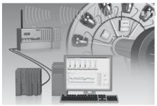
RTM (Беспроводной комплекс системы контроля натяжения) ориентирован на производственно-сбытовой цикл производства проволоки. Данные инновационные системы используют роликовые датчики для измерения натяжения отдельных проводов или пучков, и передаёт эти данные беспроводным способом от вращающейся части машины к неподвижной. Эффективность и качество выпускаемой продукции на вращающемся оборудовании значительно улучшены.
