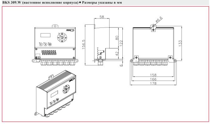
С PG-уплотнённым кабелем. Степень защиты IP 65.
